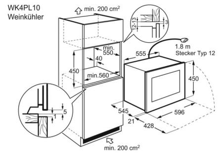
Der Weinkühler kann einzeln oder über eine Vakuumschublade eingebaut werden.
